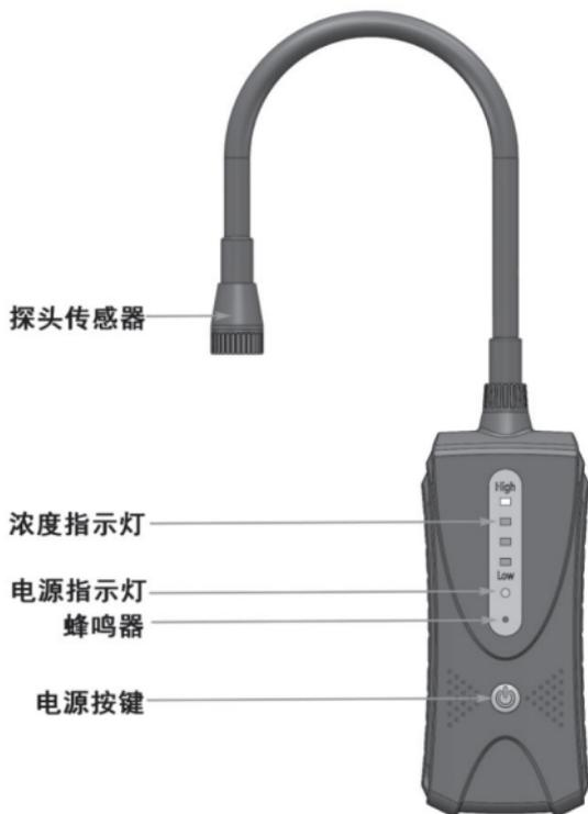
图 1 外形结构图
